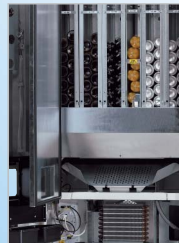
Elektronisch geregelte Hochleistungs-Einschubkühlung mit optimiertem Kühlkreislauf.
